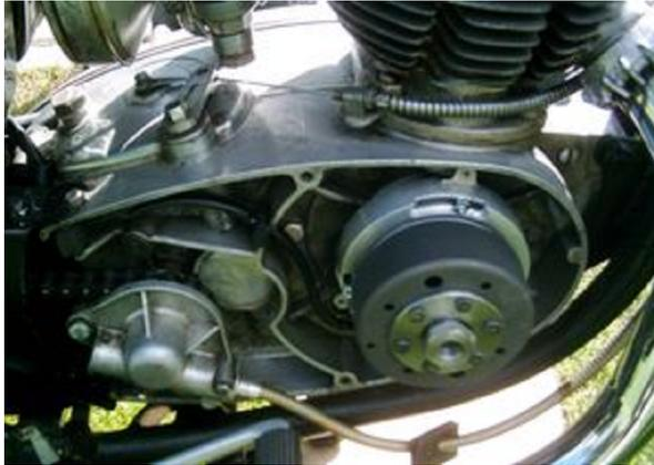
Verschrauben Sie den Rotor mit der Befestigungsmutter. Unter die Mutter kommen die beiden Scheiben 18x25x1 (wichtig!).
