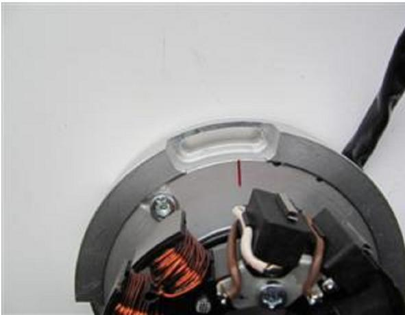
Sehen Sie sich die neue Statoreinheit an. Hier werden Sie etwas links von den schwarzen Spulen eine Markierung auf der Adapterplatte finden.
