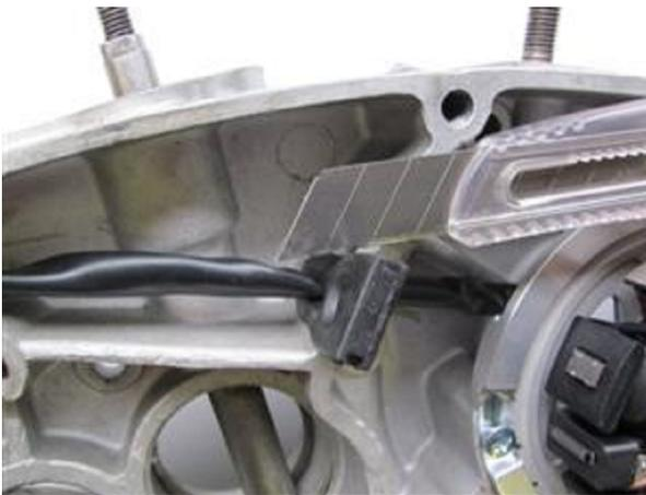
An dem Stator Kabel befindet sich eine Durchführungstülle.
