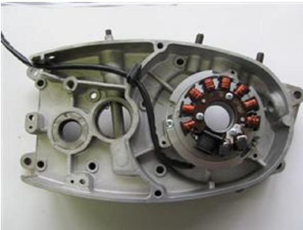
Setzen Sie die vormontierte neue Statoreinheit auf den Motorblock. Die dicke schwarze Spule weist dabei etwa in Richtung 7 Uhr. Verschrauben Sie die Einheit mit den 3 Schrauben M5.
