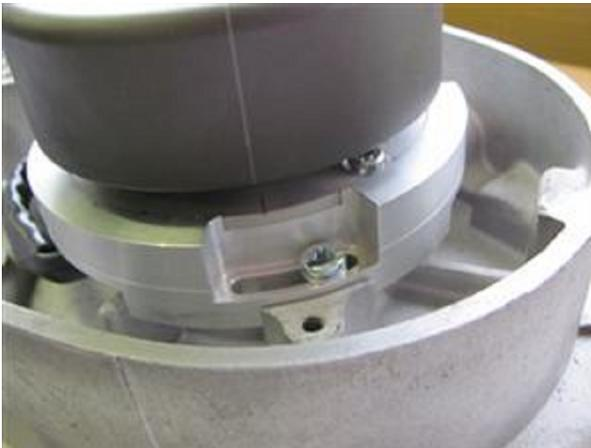
Stecken sie den Rotor nun so auf die Kurbelwelle, dass die Markierung auf dem Umfang genau an der Markierung der Adapterplatte steht und drücken Sie den Rotor fest auf die Welle. Dabei ist sehr wichtig die Stellung der Kurbelwelle (die sich im Zündzeitpunkt befindet) nicht zu verändern. Verändert diese sich, wiederholen Sie den Vorgang bitte.
